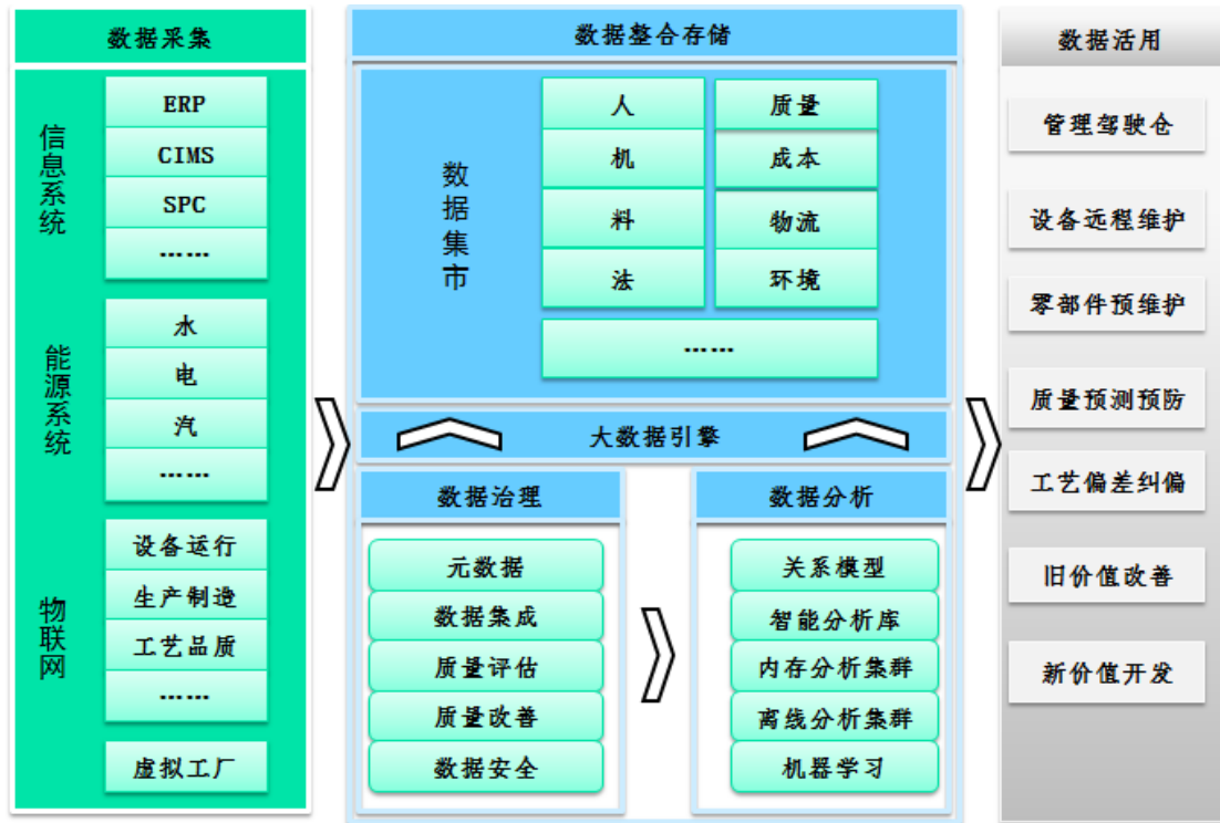
图9 仪电显示工业大数据平台架构
